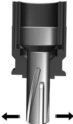
Pour vérifier si le piston est usé, il doit être dans le cylindre dans la même position qu'illustré dans l'image ci-contre.
