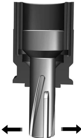
Um zu prüfen ob der Kolben verschlissen ist, muss er sich im Zylinder in ähnlicher Position wie im seitlichen Bild befinden.
