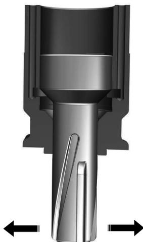
Pentru a verifica dacă pistonul este uzat, acesta trebuie să se găsească în cilindru într-o poziție similară cu cea din imaginea alăturată.
