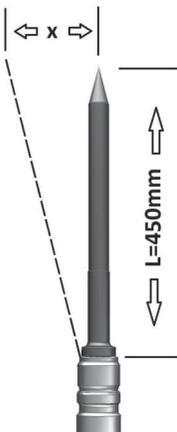
Pour vérifier l'étendue d'usure de la douille du burin, prenez un nouvel outil avec la bonne extrémité à insérer d'une longueur de 450 mm et insérez-le dans la douille du burin !
