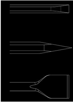
**Burin plat** : Pour les travaux de démolition et de séparation dans des matériaux durs (béton)
