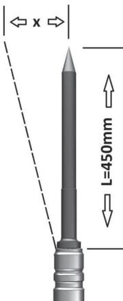
Om te controleren in hoeverre de beitelbus is versleten, neemt u een nieuw werktuig met de juiste insteek met 450 mm lengte en steekt u deze in de beitelbus!
