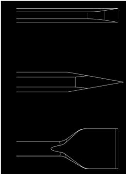
**Cinzel plano:** Para trabajos de demolición y separación en materiales duros (hormigón)
