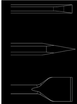
**Scalpello piatto:** Per operazioni di demolizione e separazione su materiali duri (cemento)
