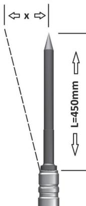
Per verificare in che misura la bussola dello scalpello è usurata, prendere un utensile nuovo con il gambo corretto della lunghezza di 450 mm e inserirlo nella bussola dello scalpello!
