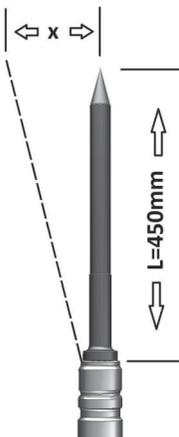
¡Para comprobar el grado de desgaste del casquillo de cincel, tome una herramienta nueva en el adaptador adecuado de 450mm de longitud e insértela en el casquillo de cincel!
