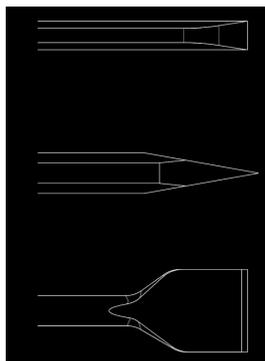
**Daltă plată:** Pentru lucrări de demolare și separare în materiale dure (beton)
