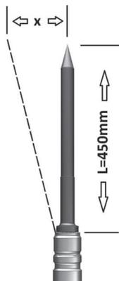
Pentru a verifica cât de mare este uzura bușei dălții, luați o sculă nouă cu cepul de fixare corect cu o lungime de 450 mm și introduceți-o în bușă dălții!
