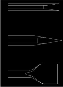
**Vlakke beitel:** Voor afbreek- en scheidingswerkzaamheden in harde materialen (beton)
