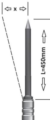
Um zu prüfen wie sehr die Meißelbüchse verschlissen ist, nehmen Sie ein neuwertiges Werkzeug mit dem richtigen Einsteckende mit 450mm Länge und stecken Sie es in die Meißelbüchse!
