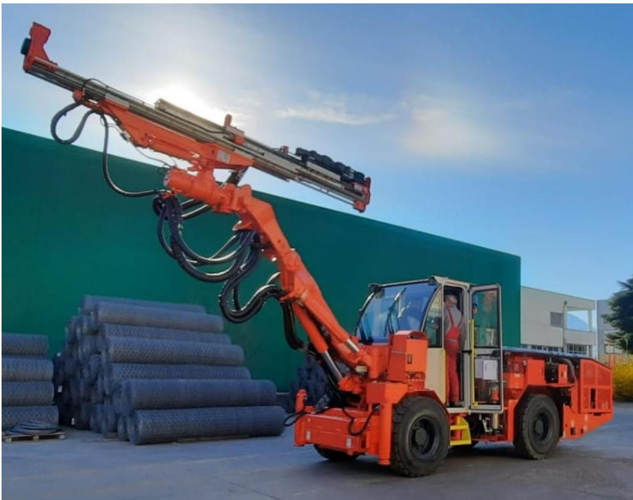
Montato su autotelaio e costruito secondo le ultime innovazioni tecnologiche, per l'esecuzione di fori da mina e bullonature in galleria. Dotato di cabina ergonomica climatizzata e riscaldata.
